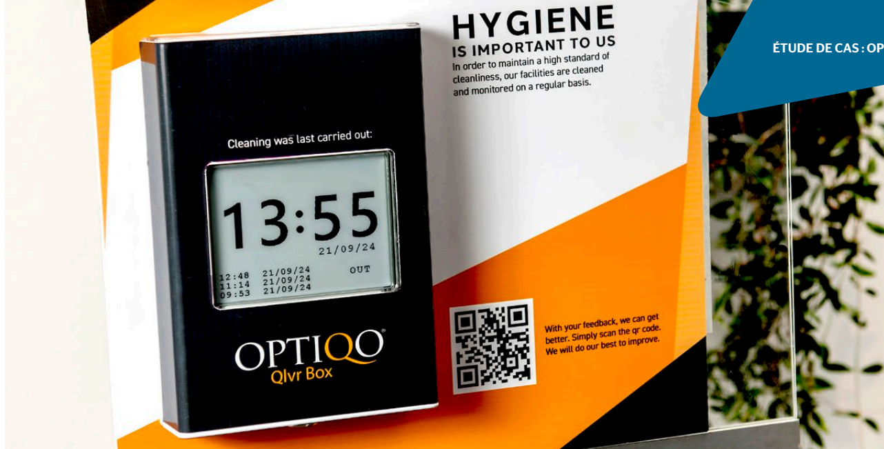
La solution d'Optiqo équipée de capteurs pour mesurer le nombre de personnes et d'un système d'affichage pour informer les visiteurs de l'état des locaux a été intégrée aux QlvrBoxes.
