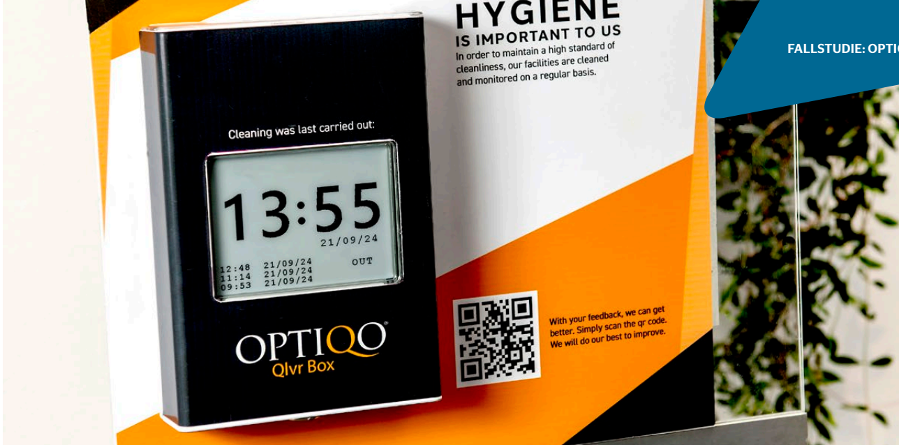
Optiqos Lösung mit Sensoren zur Messung der Abläufe wurde in sogenannten „QlvrBoxen“ mit einem Display kombiniert, das die Besucher über den Zustand des Gebäudes informiert.
