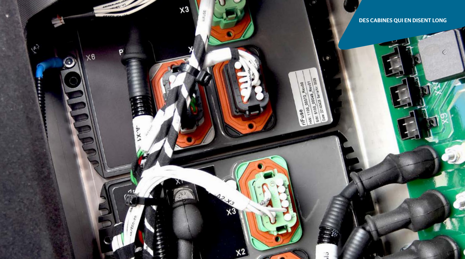
riFuse : l'unité de commande exclusive de Rimaster, intelligente et programmable.
