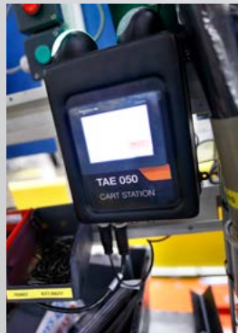
Une unité de commande à distance permet de contrôler le véhicule à partir du poste de travail.
