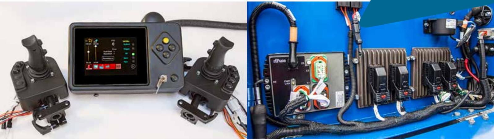
Rimaster Konsolen mit montiertem Parker IQAN LCG-Joysticks sowie Display von Rimaster mit einer Parker IQAN-MD5 Anzeige. Das Bild rechts zeigt das Triebwerk mit der Rimaster riFuse Einheit, mit der Sicherungen und Relais überflüssig werden, sowie ein Parker IQAN-Modul.
