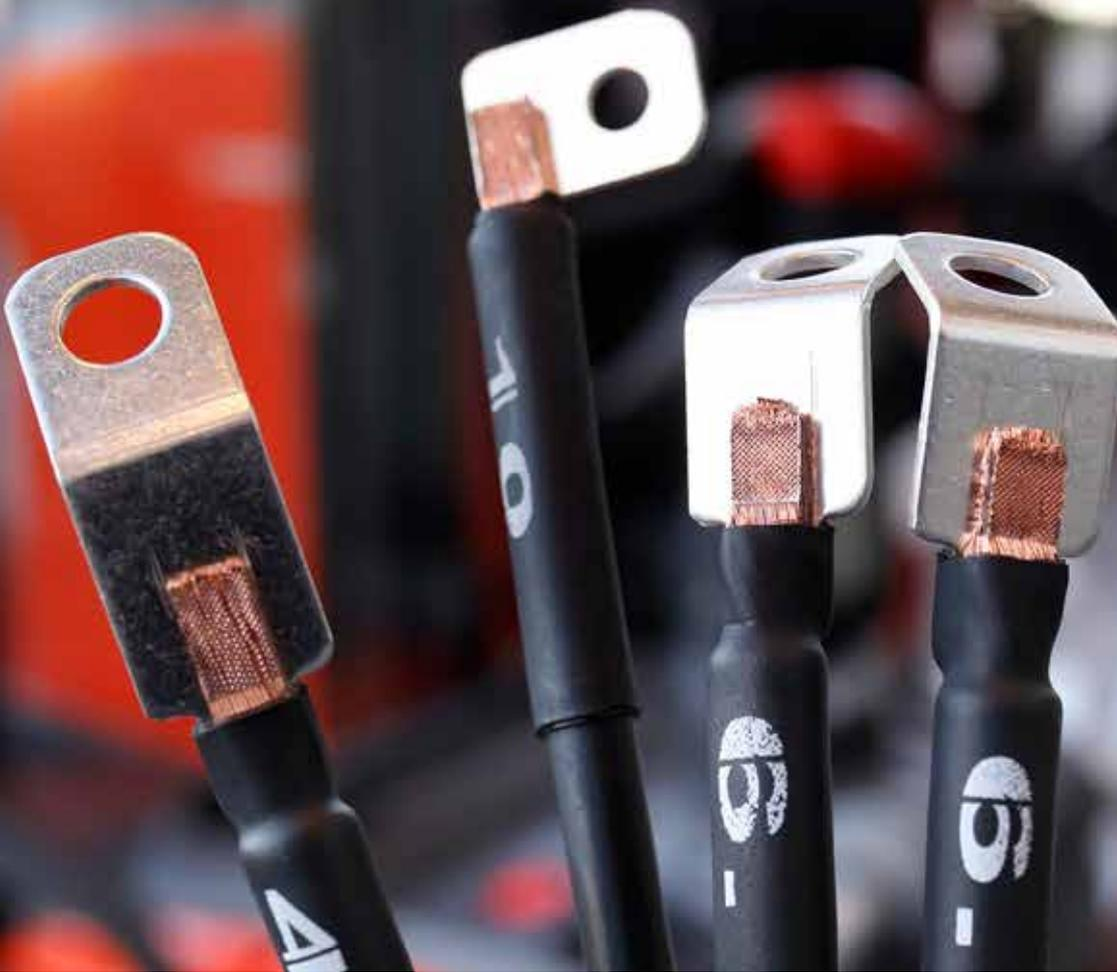
Ultraschallschweißen ist der intelligente Ansatz, um in komplexen Konstruktionen Platz zu sparen. Auf Anfrage von Toyota entwickelt Rimaster speziell auf den Kunden zugeschnittene Lösungen, die für eine höhere Flexibilität bei der Entwicklung und Fertigung sorgen.
