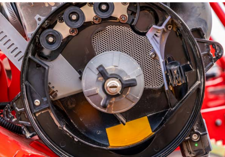
Bild links: Powershoot – ein unter Druck stehendes Zuführungssystem, das volle Kontrolle bis unter die Erde bietet. Bild rechts: Montage des WS9-Steuergeräts.
