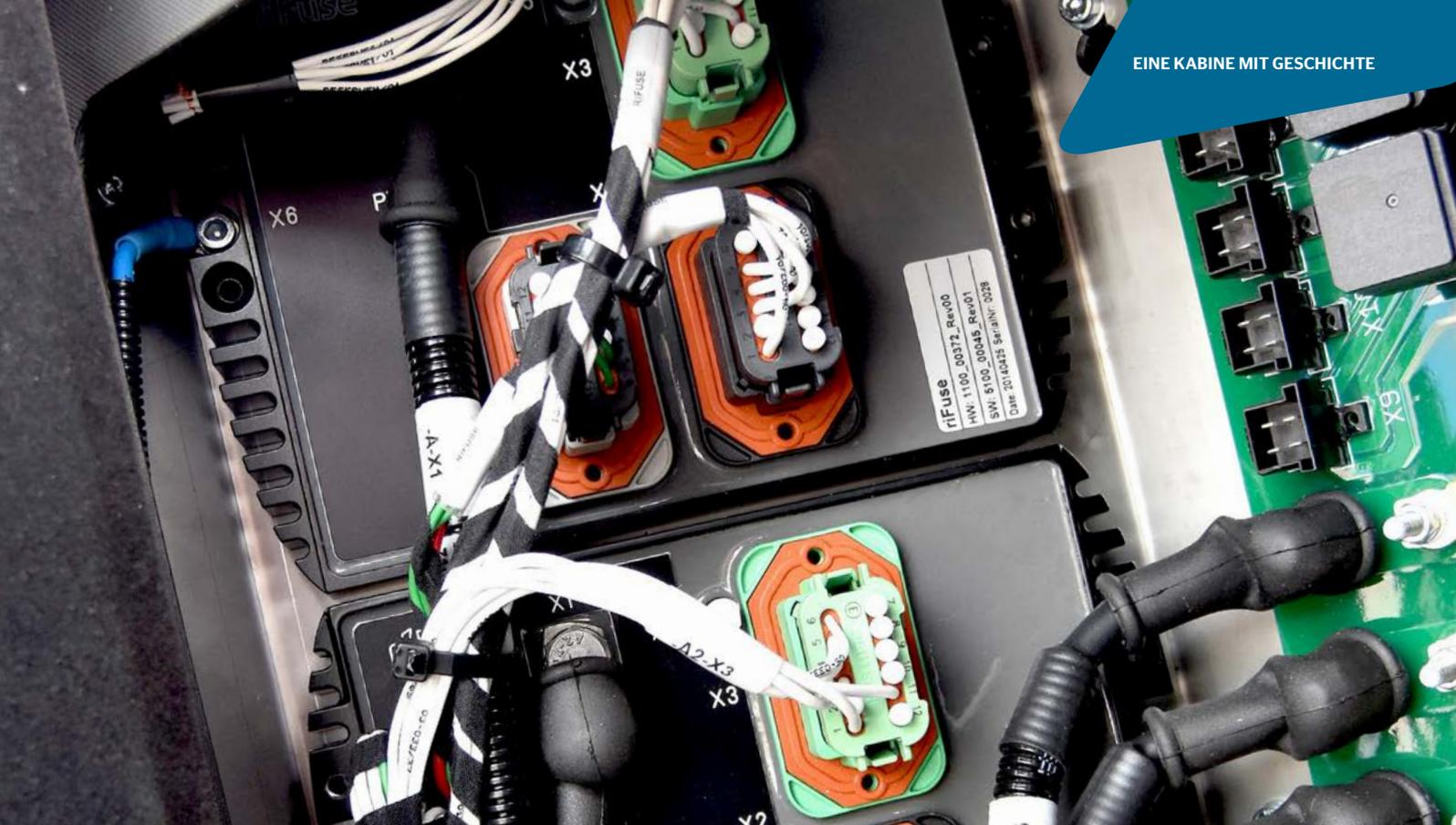
RiFuse – das proprietäre intelligente und programmierbare Steuergerät von Rimaster.
