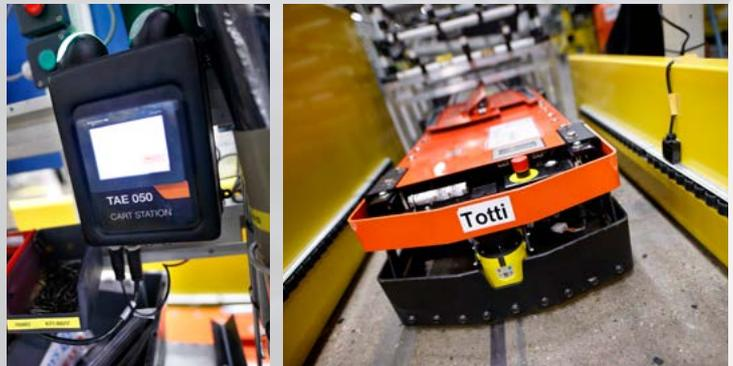
*Eine Fernsteuerungseinheit ermöglicht es, das Fahrzeug direkt von der Workstation aus zu steuern.*
