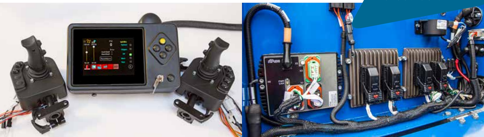
Till vänster Rimasters spakkonsoler med monterade Parker IQAN LC6 joysticks samt Rimasters displaylåda med en monterad Parker IQAN MD5 display. Bilden till höger visar huggens elcentral innehållande bland annat Rimasters riFuse-enhet, vilket gör att man slipper säkringar och reläer, samt Parkers IQAN-moduler.
