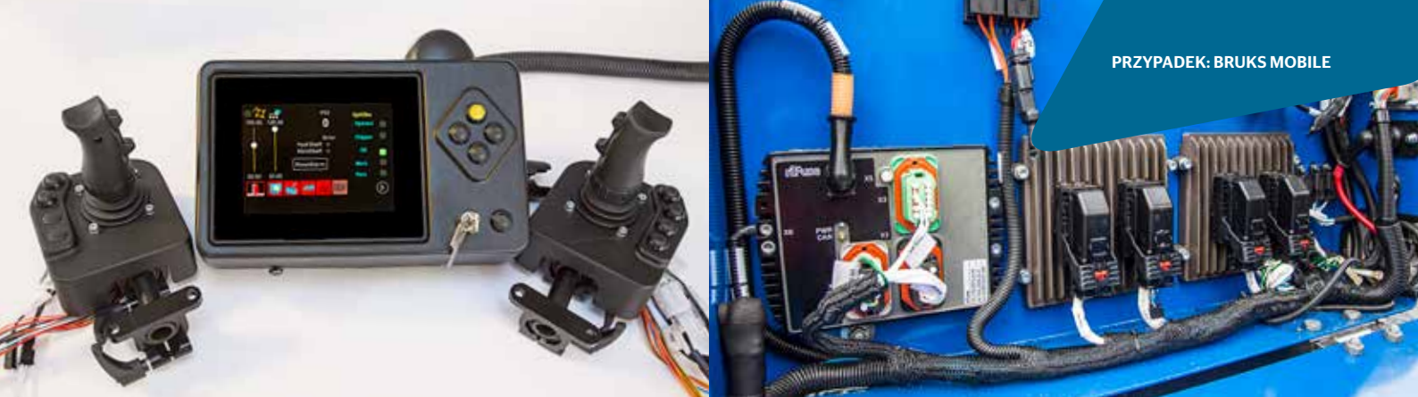
Konsola firmy Rimaster z zamontowanymi joystickami Parker IQAN LC6 oraz wyświetlacze firmy Rimaster, w tym wyświetlacz Parker IQAN MD5.
