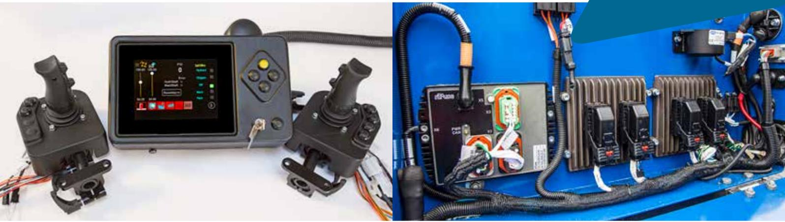
安装有 Parker IQAN LC6 操纵杆的 Rimaster 控制台和包含 Parker IQAN MD5 显示器的 Rimaster 显示装置。右图展示的发电设备中包含可淘汰保险丝和继电器的 Rimaster riFuse 装置，以及 Parker IQAN 模块。
