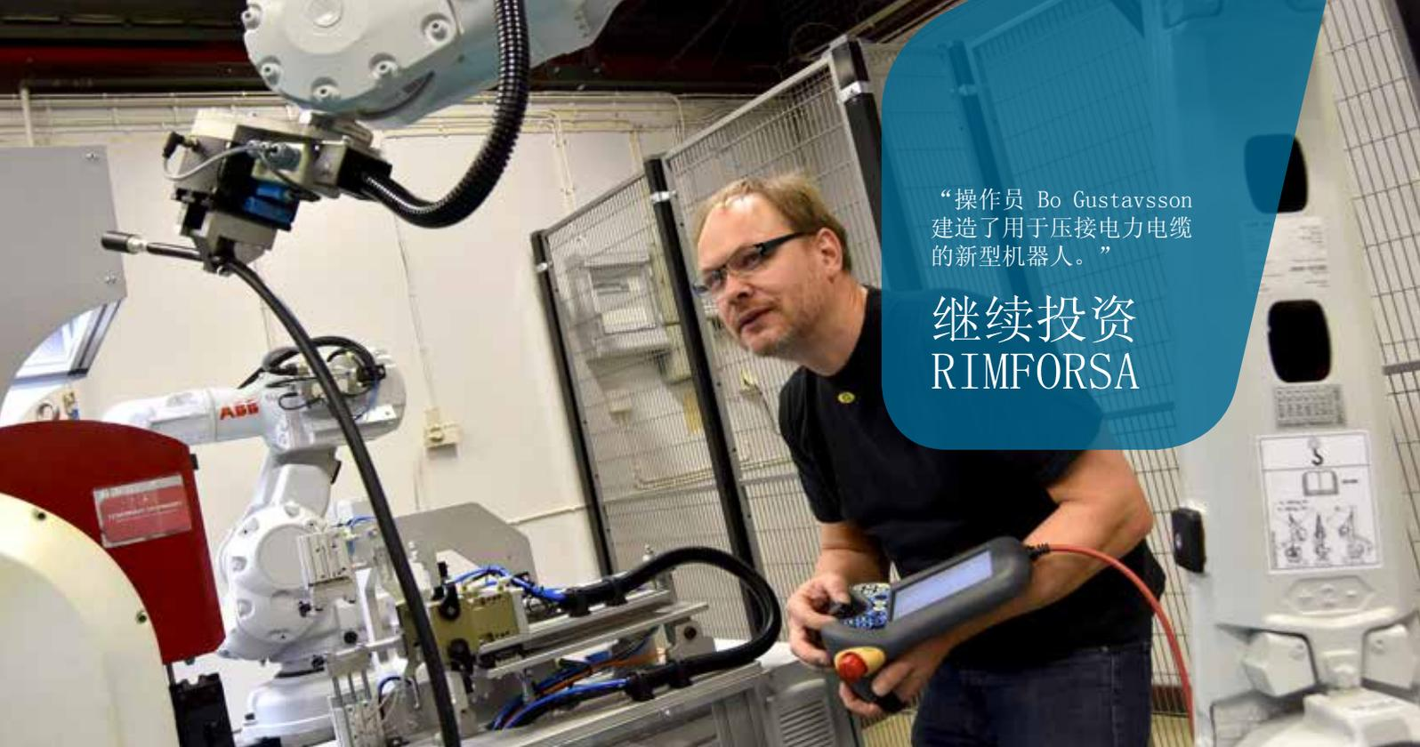
“操作员 Bo Gustavsson 建造了用于压接电力电缆的新型机器人。”
